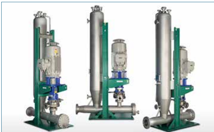
Abb. 2: Spezialkreislumpe nach dem V-AN-Verfahren: Das Fördermedium (Kohlenwasserstoff) liegt am Dampfdruck. Fördermenge: 120 bis max. 132 m 3 /h Förderhöhe : 75 m Pumpe wird mit n = 3.000 1/min betrieben.
