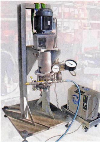
„V-AN“-Kreiselpumpen haben sich in Anlagen mit gashaltigen Gemischen oder Medien am Siedepunkt schon häufig bewährt. Ihre Vorzüge – selbstregelnd, trockenlauf- und betriebssicher – werden jetzt durch eine andere Dichtung optimiert. Die herkömmliche gasgeschmierte Gleitringdichtung wird durch Lippen-
