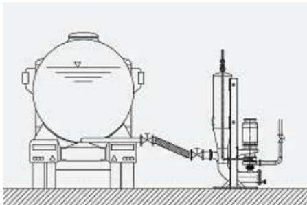
Die Spezial-Kreiselpumpe V-AN von Bungartz passt sich automatisch an die zuströmende Fördermenge an und entlüftet über eine Druckausgleichsleitung selbstständig. Durch die Druckabsenkung ohne Kavitation bis zum Siedepunkt ist auch die Entlee-
